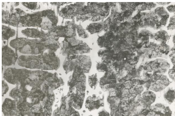
Рисунок 2 – Мікроструктура поверхневого шару при двошаровому наплавленні. (x500)
