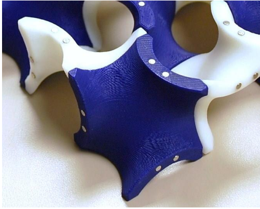
Рисунок 1 – Збирання пінопластової моделі з гіроїдною поверхнею методом з'єднання елементів світлого і темного кольору та модель комірчастої плоскої БП з такою поверхнею
