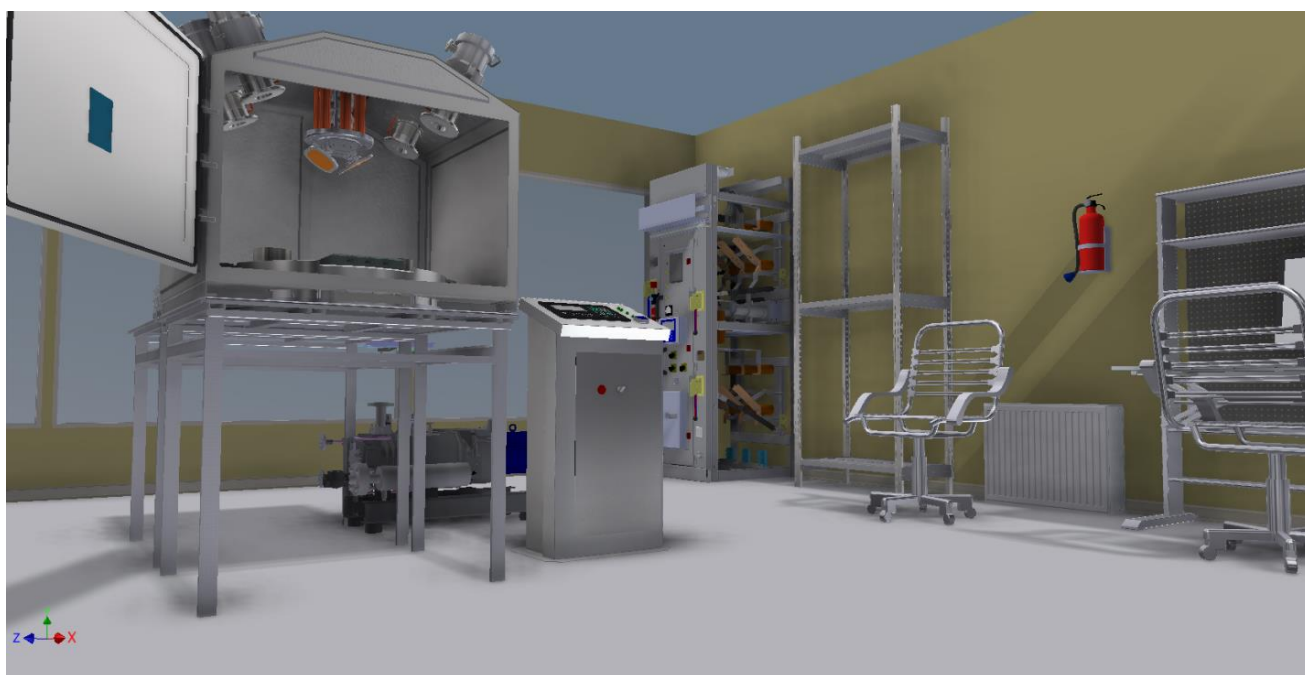
Рисунок 1 –Обладнання для синтезу вуглецевих матеріалів за методом EB PVD–CVD
