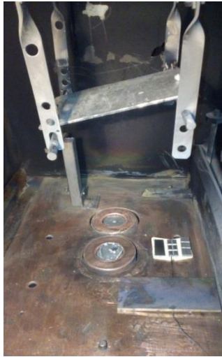
Рисунок 2 – Установка і технологічна камера з оснащенням для відбивання парового потоку вуглецю та осадження його на підкладку
