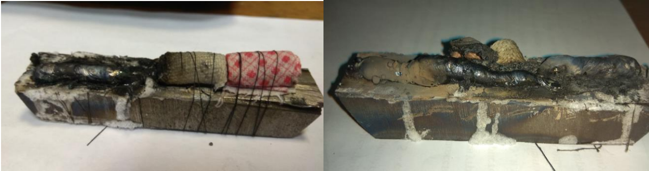
Рисунок 1 – Наплавлення високовуглецевих шарів
