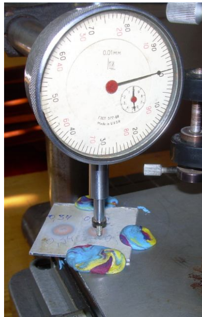
Рисунок 3 - Вимірювання висоти профіля фігури напилення
